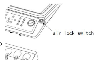
Рис. 12. Кнопка пневматического фиксатора высоты держателя для инструментов, модель BZ 637
