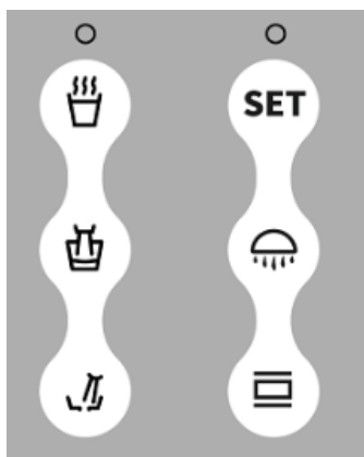
Рис. 20. Кнопка включения водонагревателя на панели управления модуля врача
